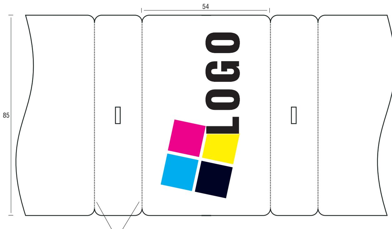
Microperforation an den Trennkanten erlaubt das einfache und saubere Herauslösen der Zertifikate aus der Bahn.
